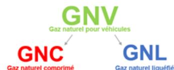
Sur les véhicules légers, il est stocké sous forme comprimée (200 bars). On l'appelle « GNC ». A ne pas confondre avec le « GNL », stocké sous forme liquide (hyper comprimé) mais réservé aux flottes de véhicules captives (poids lourds par exemple).
