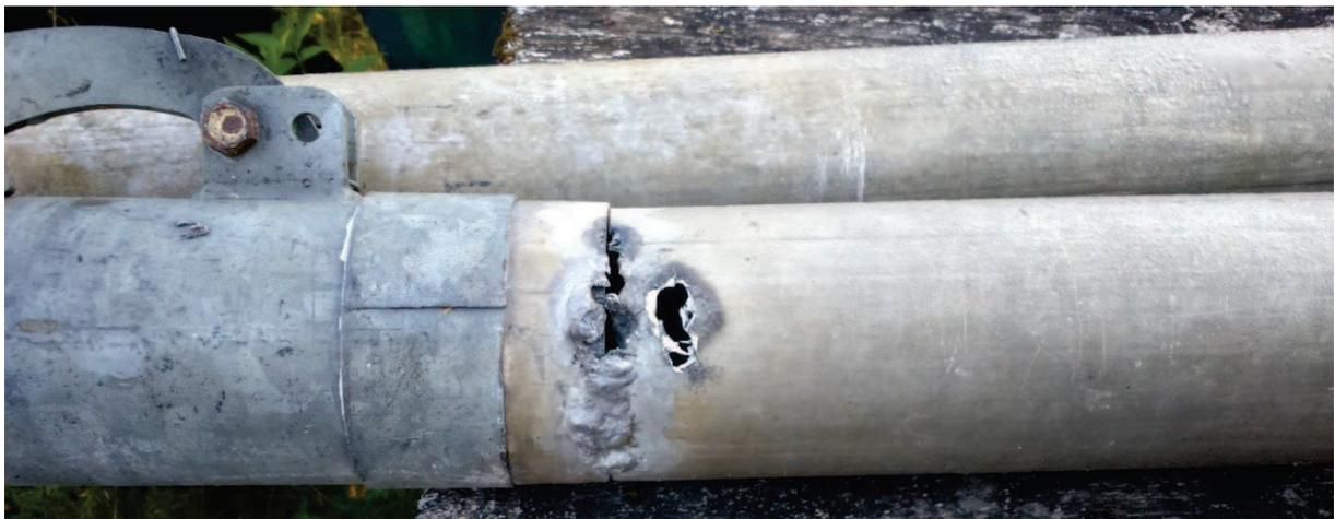
*L'aluminium ne prévient pas car il ne change pas de couleur en chauffant. Le trou est vite arrivé !*
