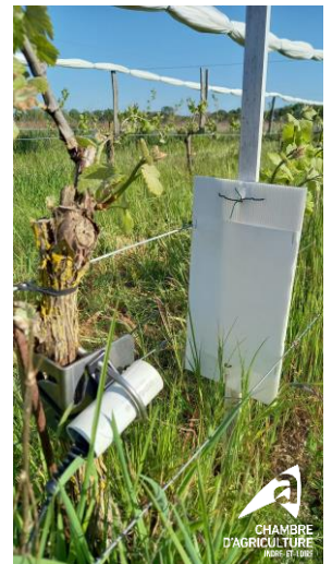
Prises de mesures infrarouges sur papier buvard pour simuler une température humide réelle (22/04/2024)
